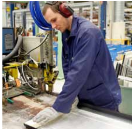
3. Muoviliistalla toisiinsa liitetty valmis peltikotelo menossa kuljettimella vaahdotusmuottiin.
