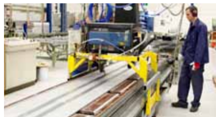
2. Katkaistu pelti ajetaan muovauskoneen läpi, jossa se muotoutuu siten, että se voidaan liittää PVC-muoviliistalla yhteen toisen kappaleen kanssa.
