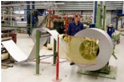
1. Lamellin tuotanto alkaa siitä, että ensin tehdään tyhjä peltikotelo, joka muodostuu kahdesta 60 senttiä leveästä peltirainasta. Ensimmäisessä työvaiheessa syöttölaite syöttää alumiini- tai peltikelasta materiaalin mittalaitteen ja leikkurin läpi, minkä jälkeen profilointikone tekee rainaan reunamuodot ja vahvikeurat.
