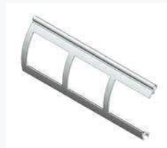
Säle 65 isoreikä 2660 , profiilit 65 mm puristettua alumiinia, stanssattu reikä 60*44 mm
