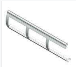
Säle 50 isoreikä 2560 , profiilit 50 mm puristettua alumiinia, stanssattu reikä 60*34 mm, soveltuu ulkokäyttöön
