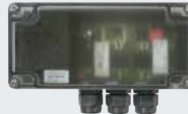
2-kanavainen relevastaanotin HET-E2 24 BS Varustettu 2 potentiaalivapaalla relälähdöllä suunnanvaihtoa varten, 2-napaisella tulolla potentiaalivapaata pääteasentoilmoitusta Ovi-auki/Ovi-kiinni varten (oven asennon kyselyä varten)
