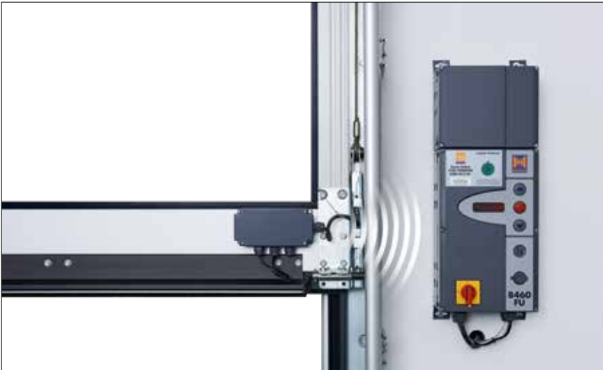
Langaton tiedonsiirto signaalin siirtämiseksi ovilehdestä Bluetoothin kautta ohjaukseen (ei kierrekaapelia), virransyöttö tehokkaan akun avulla, liitettävät komponentit: optinen tuntoreuna LE (low energy), edelläkulkeva valokenno VL1-LE / VL2-LE, sähköinen tuntoreuna, köyden höltymäkytkin, käyntiovikosketin, työntösalvan mikrokytkin
