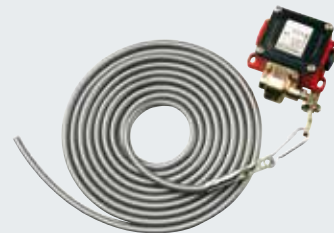
Vetokytin, jossa on muovinen vetoköysi Asennus vaaka- tai pystysuunnassa, alumiininen painevalukotelo, IP 65, köyden pituus 4 m.
