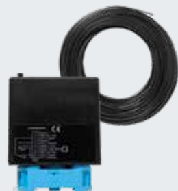
Induktiosilmukka tunnistimessa on sulkeutuva kosketin ja vaihtokosketin, asetettavissa impulssille tai jatkuvalle kontaktille, ajosuunnan tunnistus, 50 m:n silmukkakaapeli
