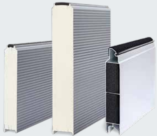
Lämpökatkaistut, teräs-sandwich-lamellit 42 ja 67 mm:n paksuisena sekä Acoustic-lamelli
