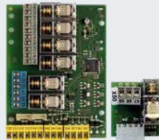
Ohjausten laajennuspiirilevy: BK 150 FU E-1 (E FU H) AK 500 FUE-1 (E FU H)
