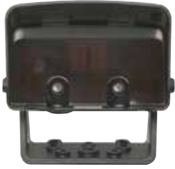
Tutkaliiketunnistin MWD-C nopea ja kohdistettu automaattinen oven avautuminen, ajosuunnan tunnistin, maks. asennuskorkeus 7 m, asennus pakastevarastossa mahdollista -22 °C saakka, IP65
