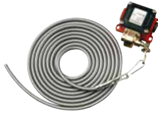
Vetokytkin, jossa on muovinen vetoköysi Asennus vaak- tai pystysuoraan, painevalettu alumiinikotelo, IP65, vetoköyden pituus 4 m
