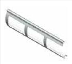
Säle 50 isoreikä 2560 , profiilit 50 mm puristettua alumiinia, stanssattu reikä 60*34 mm, soveltuu ulkokäyttöön
